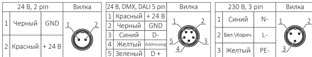
Рисунок 2. Схема подключения питания.
