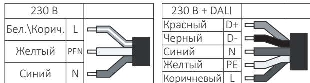
Рисунок 2. Схема подключения питания.
