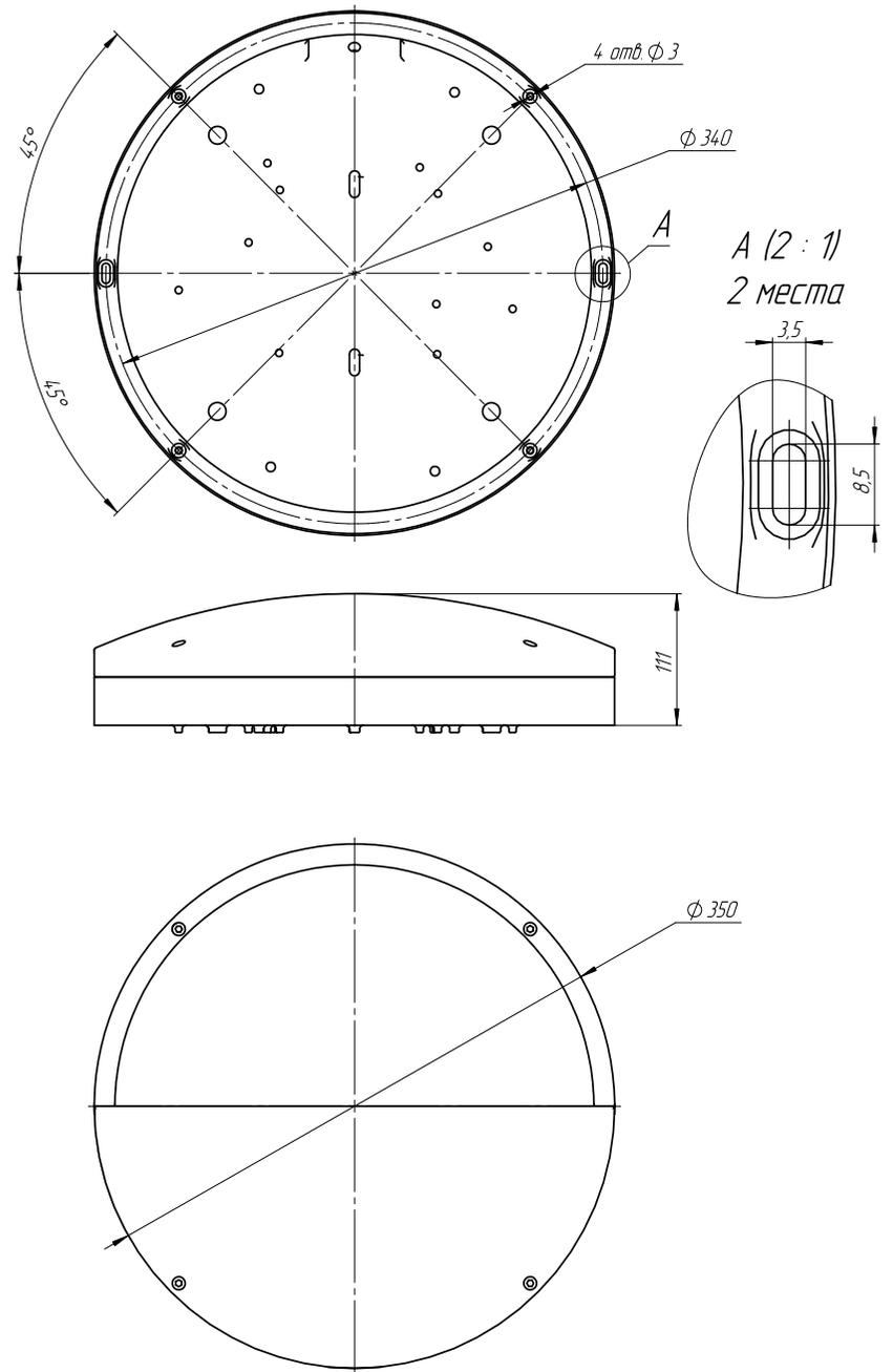
Рисунок 1. Общий вид светильника RAD-PUBLIC L
