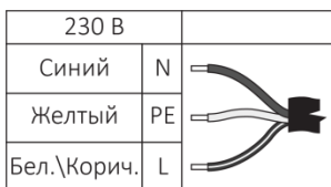
Рисунок 2. Схема подключения питания.
