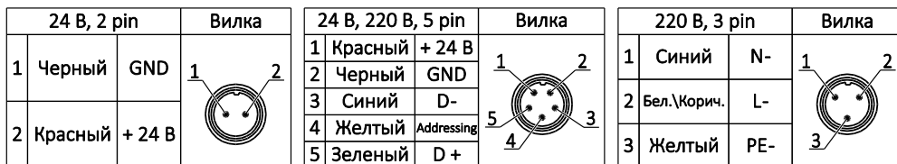
Рисунок 2. Схема подключения питания.
