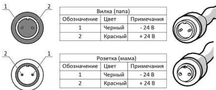
— Для последовательного подключения светильников соедините розетку одного светильника с вилкой другого. На последнем светильнике установите заглушку на свободный разъём.
