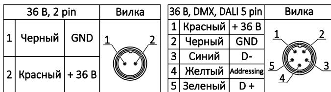
Рисунок 2. Схема подключения к сети постоянного тока.
