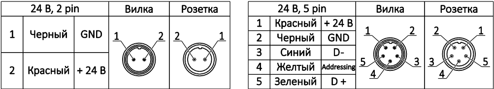
Рисунок 2. Схема подключения питания.
