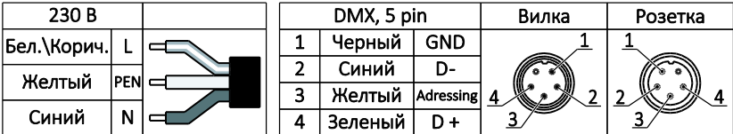
Рисунок 2. Схема подключения питания.
