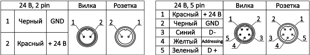
Рисунок 2. Схема подключения питания.
