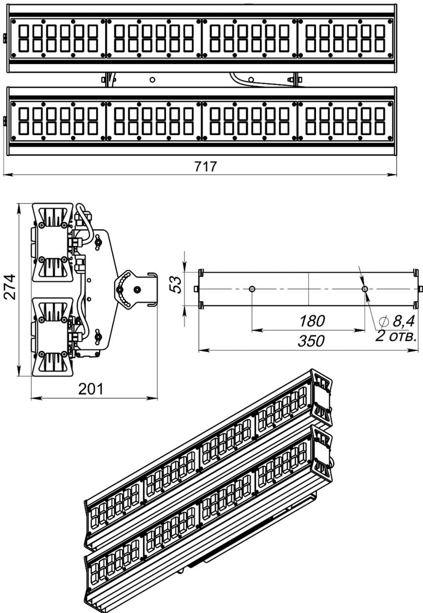
Рисунок 3. Общий вид светильника RAD-TERM В 4.2 с системой крепления S4
