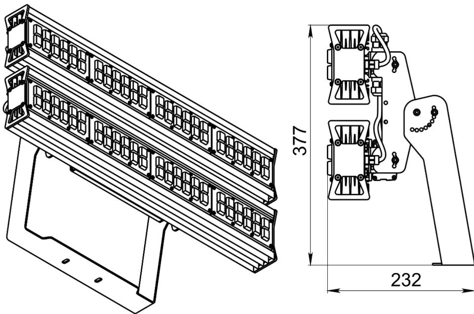
Рисунок 3. Общий вид светильника RAD-TERM B 4.2 с системой крепления S1
