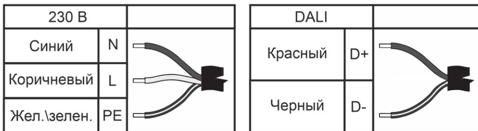
Рисунок 2. Варианты комплектных разъемов.
