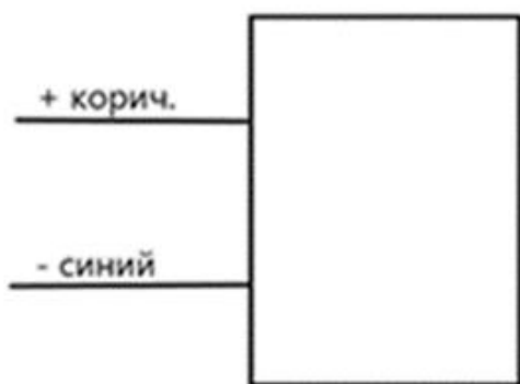
Схема подключения к сети постоянного тока ( 24, 48 В)
