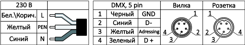
Рисунок 2. Схема подключения питания.
