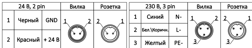
Рисунок 2. Схема подключения питания.
