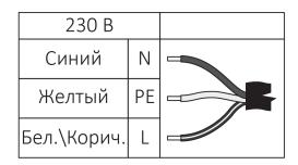
— Светильник не оснащен разъёмом питания. Электроподключение светильника осуществляется при помощи соединения проводов светильника с проводами питающей сети 230 В при помощи кабельного соединителя IP67.
