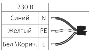
Рисунок 2. Схема подключения питания.
