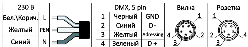
Рисунок 2. Схема подключения питания.
