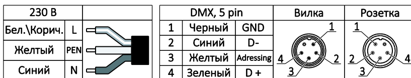
Рисунок 2. Схема подключения питания.
