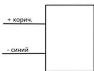
Схема подключения ети постоянного тока ( 24, 48 В)
