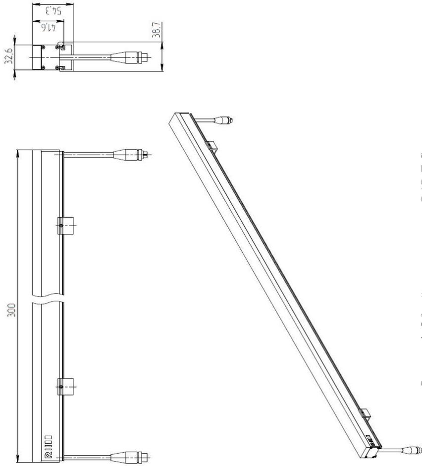
Рисунок 1. Общий вид светильника RAD-T-Cu
