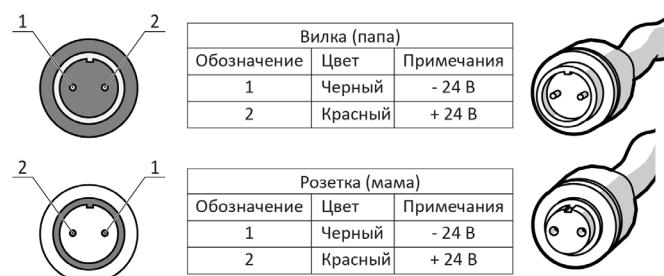
— Для последовательного подключения светильников соедините розетку одного светильника с вилкой другого. На последнем светильнике установите заглушку на свободный разъём.
