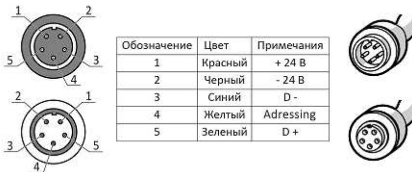
**Рекомендованная схема подключения светильников представлена на рисунке.**
