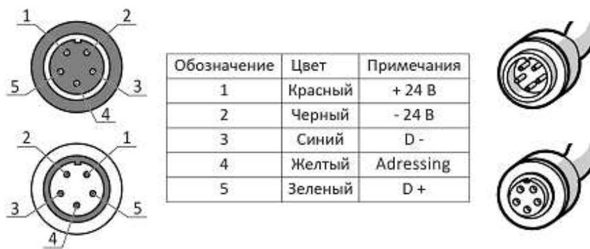
Рекомендованная схема подключения светильников представлена на рисунке.
