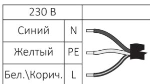
Рисунок 2. Схема подключения питания.
