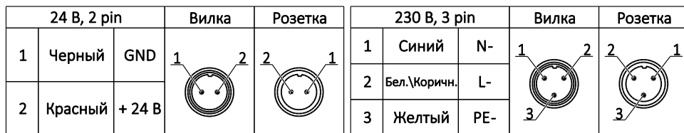
Рисунок 2. Схема подключения питания.
