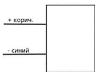
Схема подключения ети постоянного тока ( 24, 48 В)
