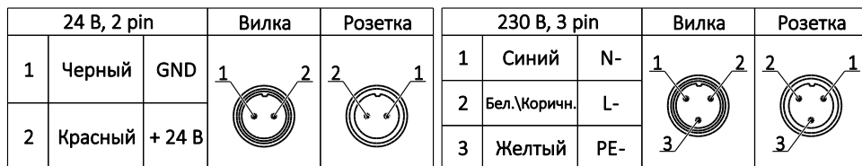
Рисунок 2. Схема подключения питания.
